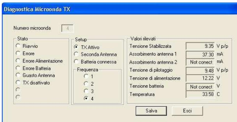
Sulla parte destra della finestra la finestra di diagnostica mostra i valori analogici principali del TX, i quali possono essere analizzati e confrontati con le gamme corrette di valori che tali parametri devono avere per un loro corretto funzionamento. Vi sono 6 valori :
