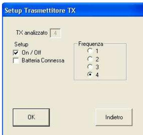
Dopo aver cambiato i parametri (on/off e frequenza), la pressione del bottone OK memorizzerà i nuovi settaggi (facendo tornare contemporaneamente attiva la finestra di diagnostica, dove le modifiche saranno visibili). La pressione del bottone Cancel invece chiuderà la finestra senza nessun salvataggio.
